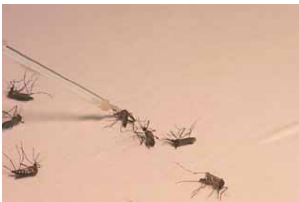
Figure 1. Topical application of insecticide to the pronotum of anaesthetized mosquitoes (courtesy of Institut de Recherche pour le Développement, Montpellier, France).
