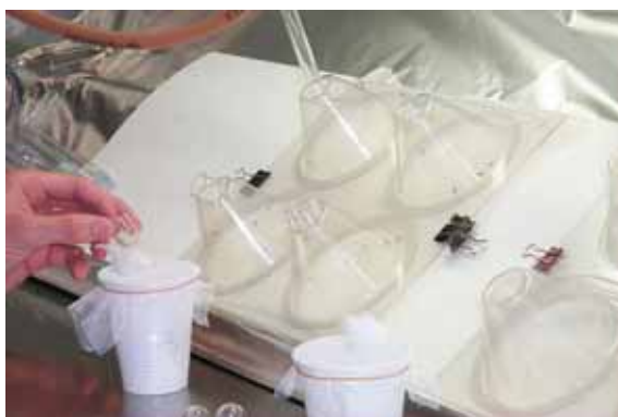
Figure 2. Cone bioassay on mosquito nets (courtesy of Dr Vincent Corbel, Institut de Recherche pour le Développement (IRD), Montpellier, France).
